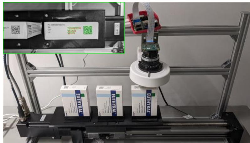
Figure 3 : Illustration d'un démonstrateur de lecteur de codes sur des emballages pharmaceutiques.
